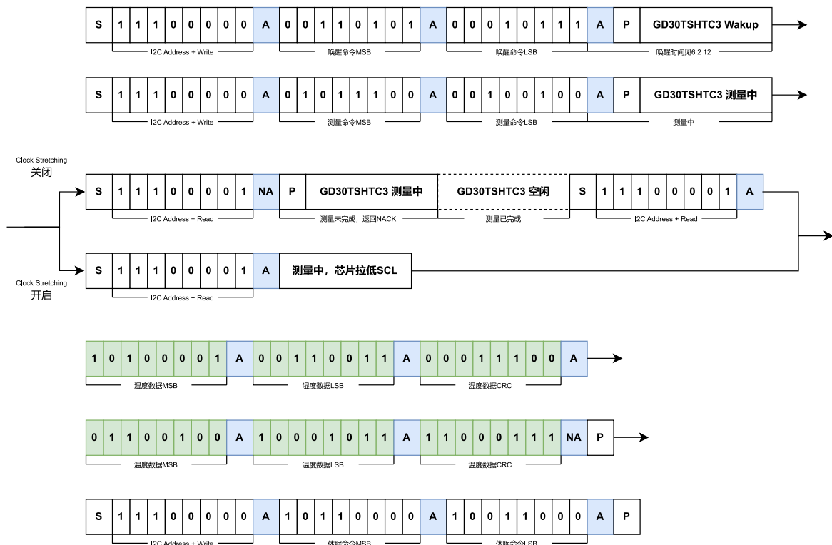
图 5. 唤醒，开始温湿度测量，温湿度转换和休眠命令执行顺序示意图
